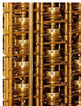
Frammento della macchina alle differenze esposta al London Science Museum e particolare ingrandito
